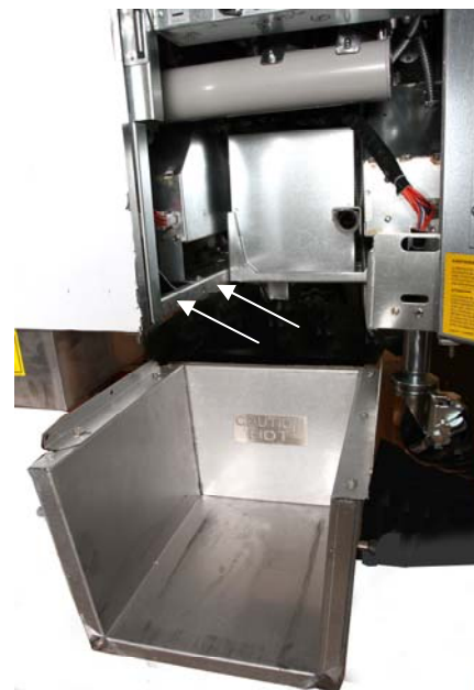
Figure 1 : Placez le bac de fusion dans l'armoire et fixez-le avec les vis fournies à l'intérieur de l'armoire.
